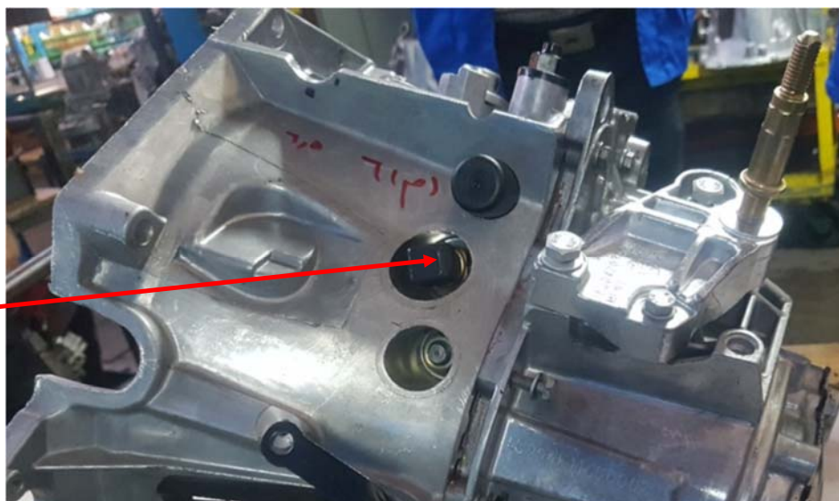
سویچ دنده عقب گشتاور بستن سوئیچ دنده عقب: 20-30(N.M)
