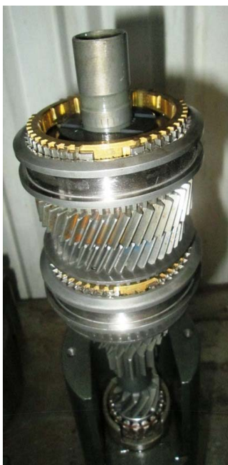
دنده ۶ و بوش چرخ دنده را از محل خود خارج کنید.
