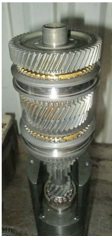
دنده ۶ و بوش چرخ دنده را از محل خود خارج کنید.
