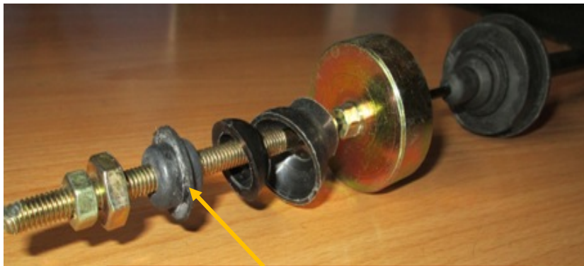
قطعه لاستیکی شماره یک بر روی سیم کلاچ 03018010
