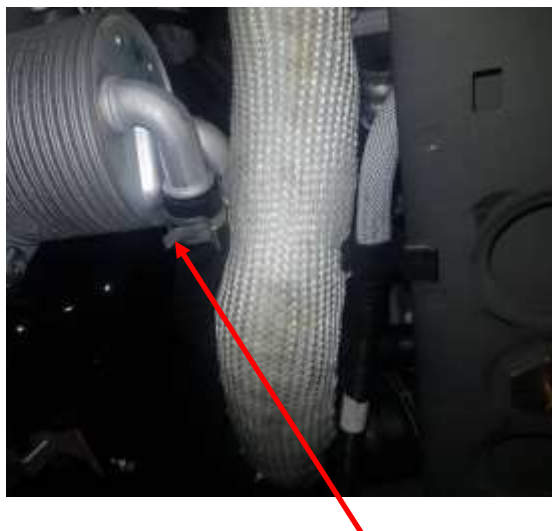
بست لوله های رفت و برگشت آب به رادیاتور روغن
