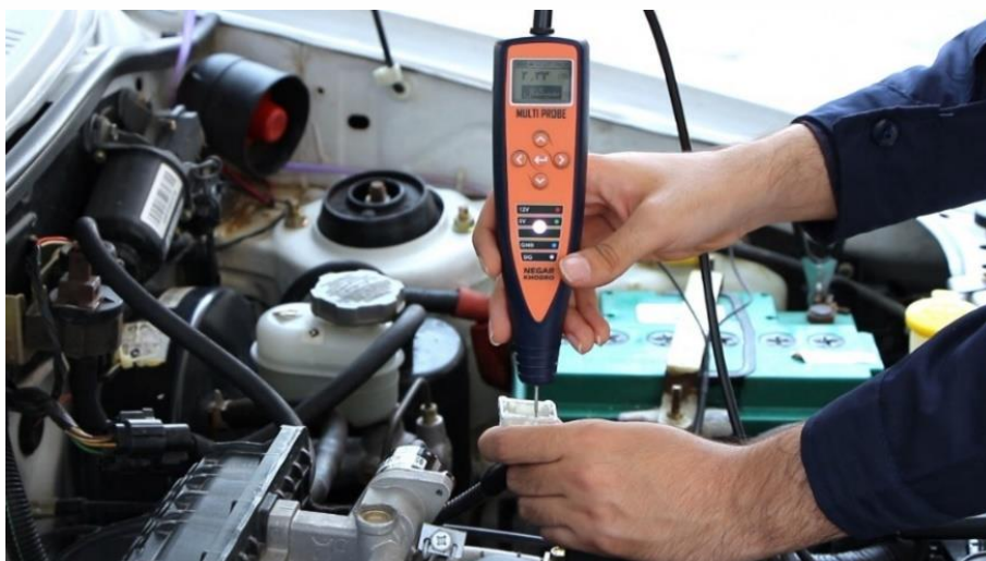
تست پایه‌های سنسور دریچه گاز
