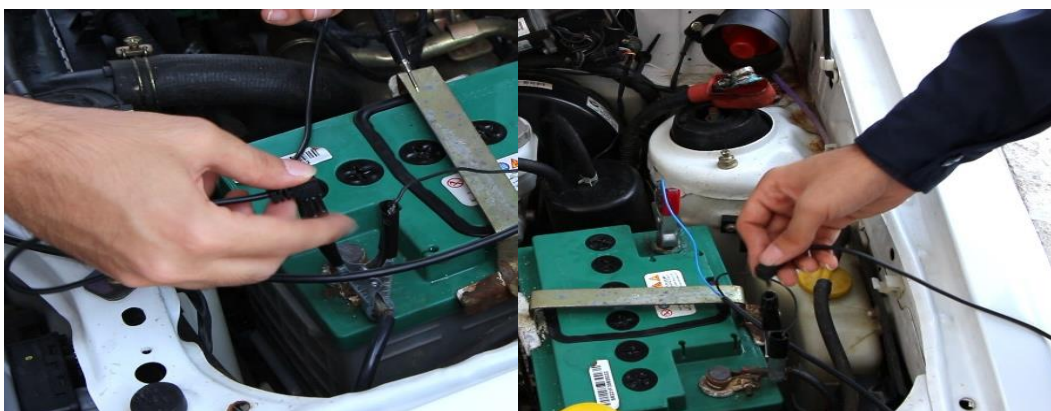
نصب پروب رابط به گیره سوسماری
