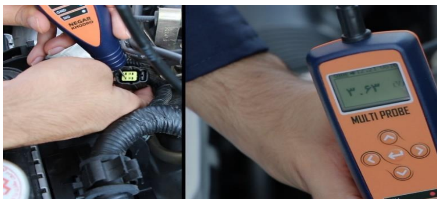
تست سنسور اکسیژن
